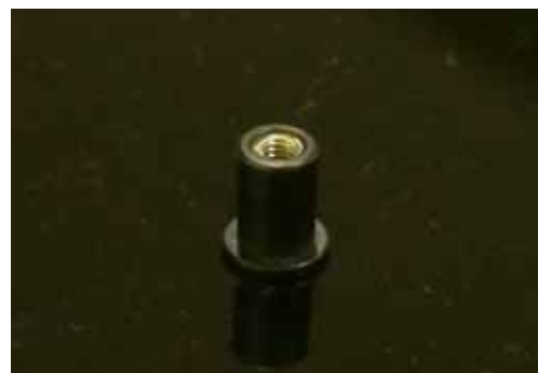
右下／將單體固定到箱體上的螺絲孔也有學問，用塑膠套筒與箱體耦合，隔離箱體振動對單體的干擾。
